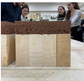
52. Κατασκευή δείγματος πατώματος από πατητή γη και ξύλο με φοιτήτριες και μέλη του αρχιτεκτονικού γραφείου ZRS στα πλαίσια του προγράμματος Greenest.
