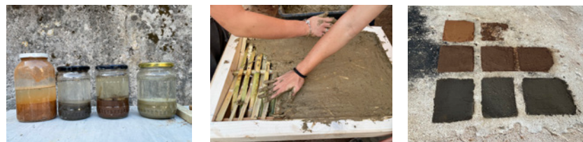
99. Δοκιμαστικά τεστ ελέγχου του χώματος και εφαρμογή του.
