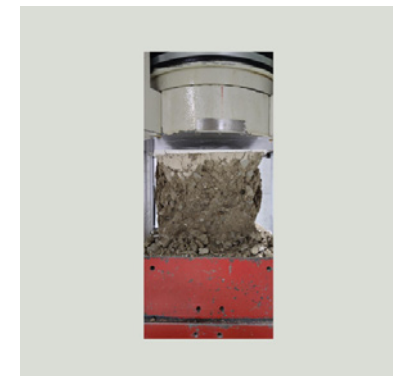
83. Δοκιμή θλίψης στο ερευνητικό εργαστήριο του ΕΘΓ, για τον προσδιορισμό της μέγιστης αντοχής του πηλού σε θλίψη.
