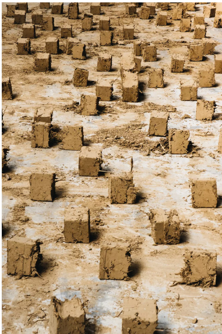
50. Δοκίμια κύβων κατασκευασμένα από χώμα και άχυρο, BC materials.
