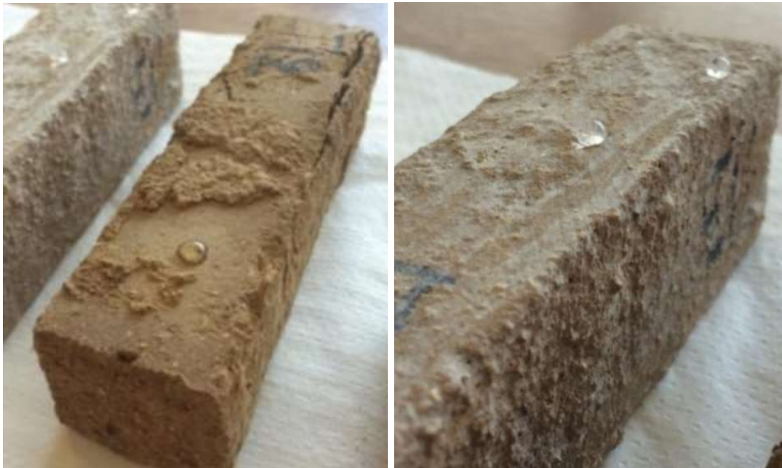
Εικόνες 5.20 & 5.21 Δοκιμή απορρόφησης σταγόνας μετά από επάλειψη με λινέλαιο (αριστερά) και siloxane με nanosilica (δεξιά). 99
