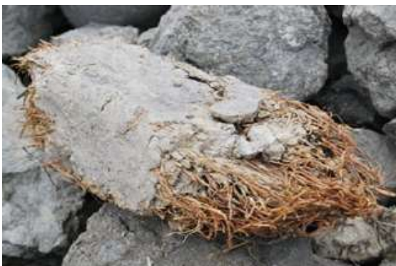
Εικόνα 1.12 & 1.13. Αριστερά: Δομική μονάδα μικρού βάρους από άχυρο και λάσπη. Δεξιά: Ξύλινος σκελετός σε χωμάτινο τοίχο στην κορυφή της πυραμίδας του Caral, Περού. 26
