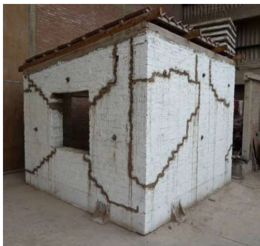
Εικόνες 5.7 & 5.8: Το αρχικό και το επισκευασμένο μοντέλο των (Blondet, Vargas-Neumann and Groenenberg 2012)
