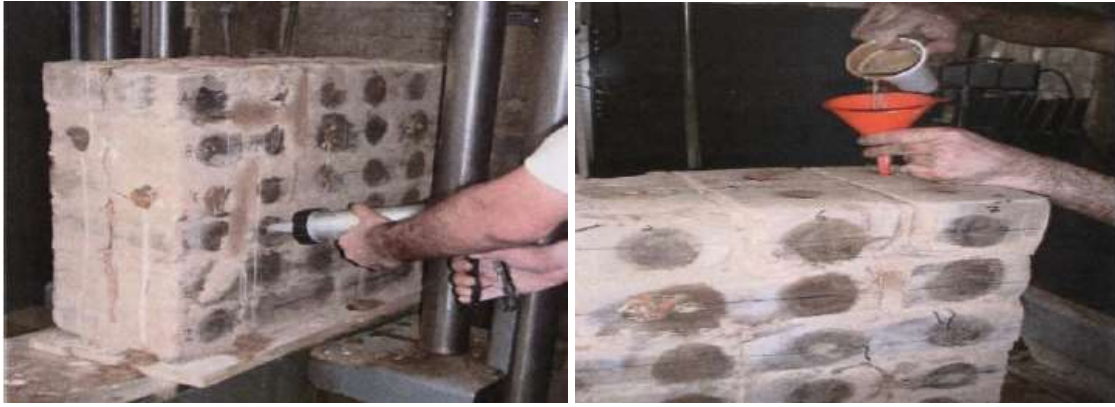
Εικόνες 5.11 & 5.12 Τοποθέτηση των ενεμάτων στους τοιχίσκους με πιστόλι σιλικόνης (αριστερά) και με την βαρύτητα (δεξιά) 85 .
