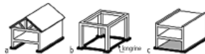
Figure 10a. Semelles de fondations: a - filante, b - isolée, c - radier général (M. Zacek, 1996).
